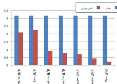
شکل ۱۴- سهم تنش برشی و فشار بر حسب فاصله مرکز ذرات از دیواره پایینی، \frac{d}{H} ، برای ذرات با قطر 5.1/7 میکرومتر
