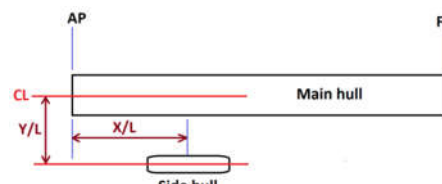
شکل ۷- جانمایی بدنه‌های جانبی بر اساس متغیرهای بی‌بعد
