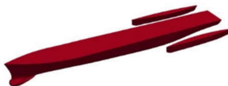
شکل ۱- طرح شناور سه‌بدنه‌ی تحلیل شده در این پژوهش
