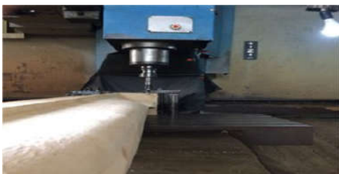
شکل ۲- فرایند ساخت مدل چوبی توسط دستگاه برش سه‌بعدی
