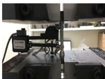
شکل ۸- دستگاه تست کشش SANTAM STM400 و نصب اکستنسومتر بر روی نمونه
