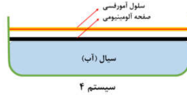
شکل ۱۰- انواع مختلف سیستم STPV/T مورد مطالعه
