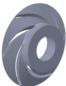
شکل ۴- مدل هندسی ایمپلر پمپ استفاده شده در شبیه سازی
