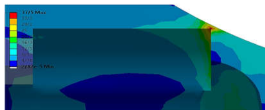
شکل ۹- نمای جانبی تنش در پله شافت در شعاع گردی ۳۵ mm
