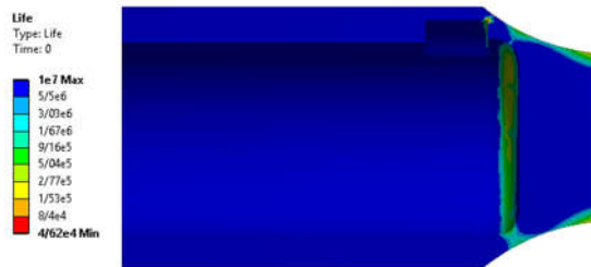
شکل ۲۰- عمر خستگی از روش اجزا محدود بر اساس معیار مورو
