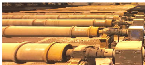
شکل ۱- غلنتک های انتقال شمش در کارخانه فولاد سازی گروه ملی
