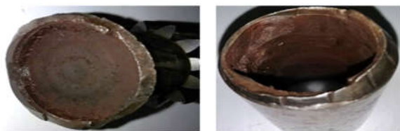
شکل ۱۰- شکست محور از ناحیه پله
