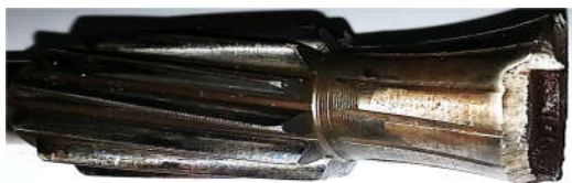
شکل ۱۱- شکست محور از ناحیه پله در محل وجود شیارها
