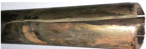
شکل ۱۲- شکست محور از ناحیه خار
