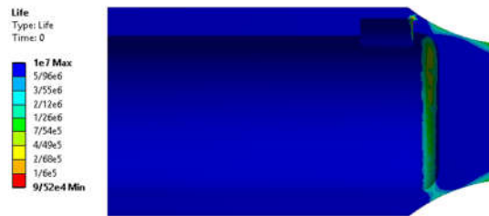
شکل ۱۹- عمر خستگی از روش اجزا محدود بر اساس معیار SWT
