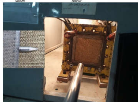
شکل ۱۱- طرحواره دستگاه آزمون ضربه بالستیک، شکل پرتابه و شرایط تکیه گاهی سازه هدف
