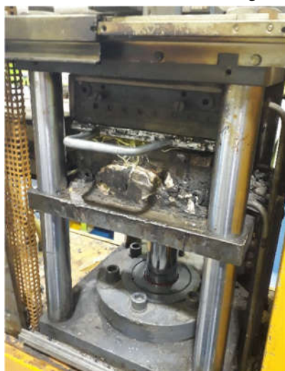
شکل ۴- فرآیند پخت به روش پرس گرم پارچه و تهیه کامپوزیت
