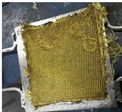
شکل ۵- نمونه کامپوزیت حلقوی-پودی پس از پخت
