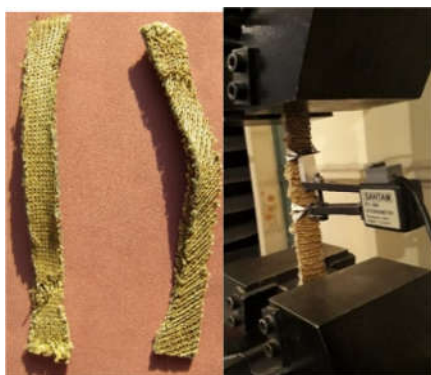
شکل ۷-آزمون کشش در جهت نرمال (سمت راست) و نمونه‌های نرمال و برشی پس از آزمون (سمت چپ)
