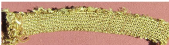
شکل ۳- پارچه بافته‌شده به روش حلقوی-پودی و قبل از پخت
