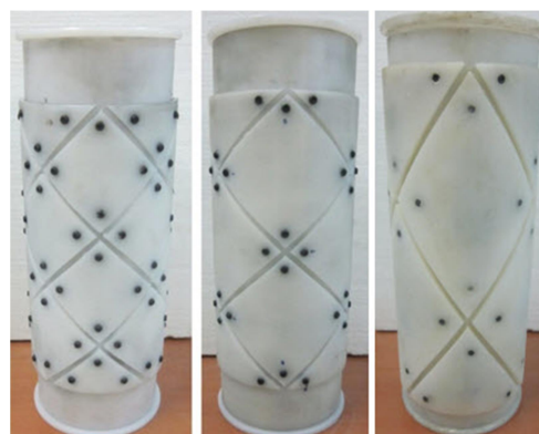
شکل ۲- قالب‌های پلی‌ایتیلنی ساخت نمونه‌ها
