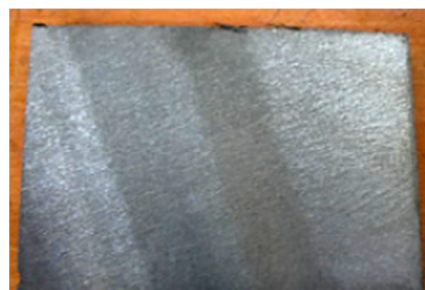
شکل ۴- تصویر ماکروسکوپی از مقطع آماده سازی شده نمونه "الف". محلول اچ: نایتال ۱۰٪
