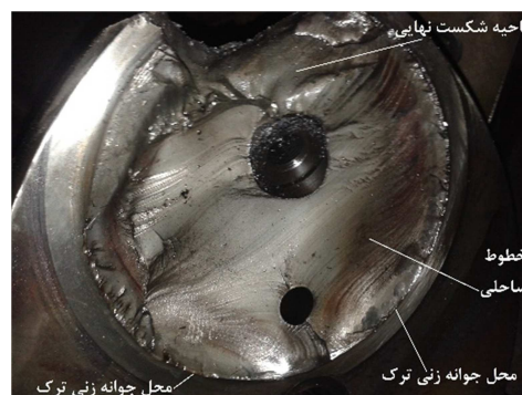
شکل ۳- سطح شکست در محل اتصال محور لنگ به لنگ بر روی لنگ
