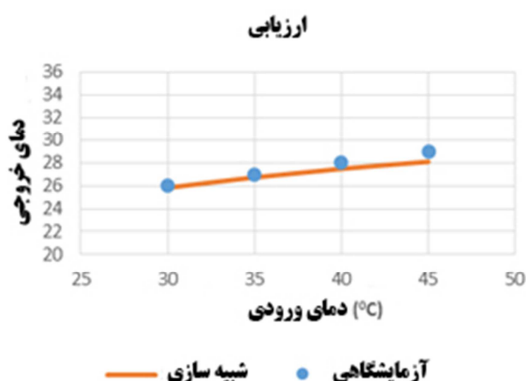
شکل ۵- نمودار دمای خروجی بر حسب دمای ورودی در دو حالت شبیه سازی و آزمایشگاهی
