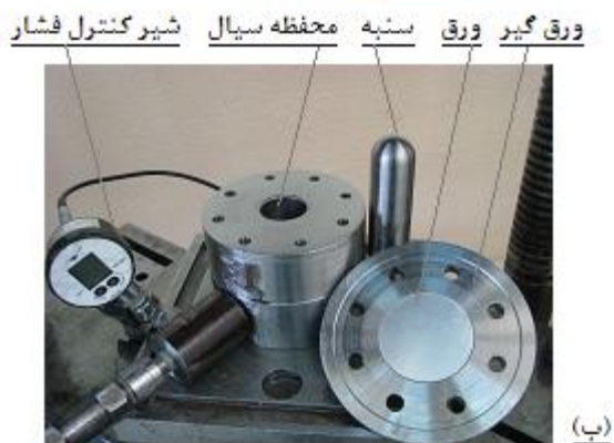
شکل ۵- الف- دستگاه پرس و واحد هیدرولیکی مورد استفاده در آزمایشات ب- مجموعه قالب ساخته شده
