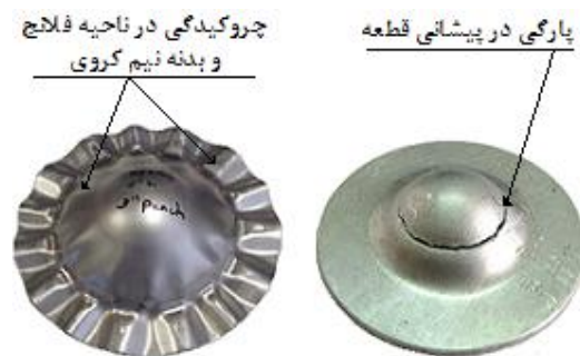
شکل ۲- پارگی و چروکیدگی ایجاد شده در شکل‌دهی قطعات نیم‌کروی با روش کشش عمیق معمولی
