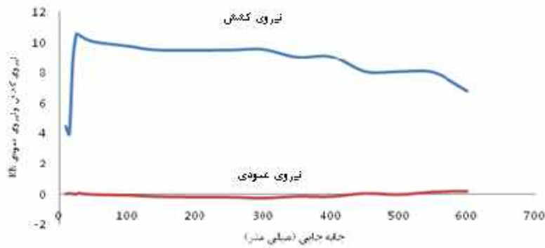
شکل ۳- نمودار نیروی کشش (بالایی) و نیروی عمودی (پایینی) عمل کننده روی تیغه در برابر جابه جایی
