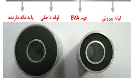
شکل ۱- اجزای تشکیل دهنده سازه های ساندویچی
