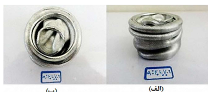
شکل ۶- نحوه چین‌خوردگی نمونه O_1IF_0L_00 (الف) نمای روبرو. (ب) نمای بالا
