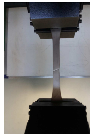
شکل ۱۱- نمونه استاندارد تهیه شده از فولاد ضد زنگ 316L در آزمون کشش حین شکست
