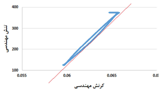
شکل ۱۵- جزییات نمودار باربرداری الاستیک با انجام برازش خطی جهت اندازه گیری مدول الاستیک
