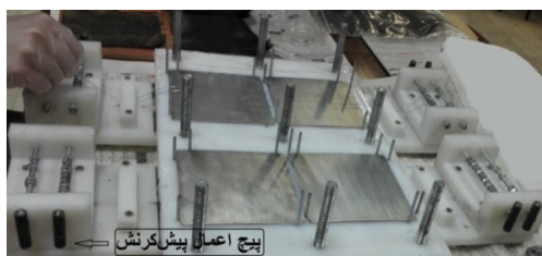
شکل ۱- فیکسچر ساخت نمونه و مکانیزم اعمال پیش‌کرنش
