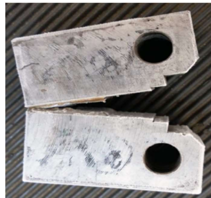
شکل ۱۰- تصویر یک نمونه CT پس از شکست ترد
