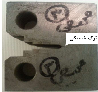
شکل ۸- تصویر یک نمونه CT با ترک خستگی
