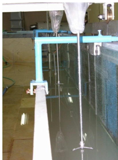
شکل ۴- از بالا به پایین به ترتیب نمایی از پروپ اندازه‌گیری و عکسی از سرعت سنج
