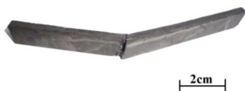
شکل ۸- نمونه آزمون خمشی پس از آزمایش خمشی سه نقطه ای
