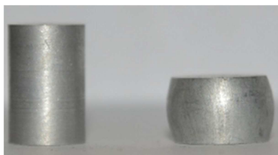
شکل ۱- نمونه آلومینیوم ۲۰۳۰ قبل (نمونه سمت چپ) و بعد (نمونه سمت راست) از آزمایش فشار داغ
