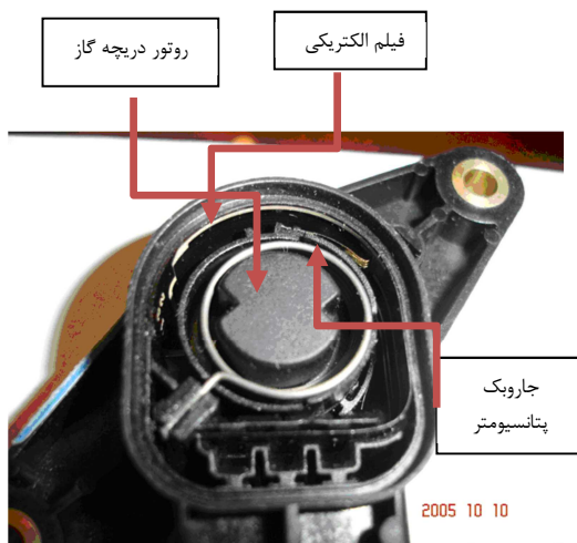
شکل ۱- طرحواره اجزا تشکیل دهنده پتانسیومتر موتور XU7.
