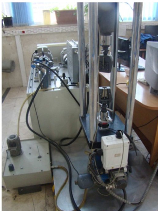
شکل ۷- دستگاه آزمایش خستگی سروهیدرولیک
