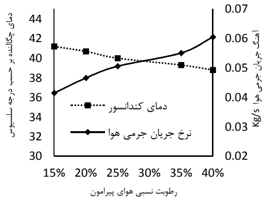
شکل ۴- تغییرات دمای چگالنده بر حسب رطوبت نسبی در دمای ثابت ورودی 30^{\circ}C
