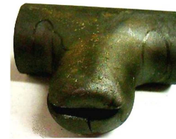
ترکیدگی در انتهای برآمدگی چروکیدگی در محل سه راهی شکل ۳- نمونه‌هایی از عیوب ایجاد شده در حین ساخت قطعه
