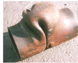
ترکیدگی در انتهای برآمدگی چروکیدگی در محل سه راهی شکل ۳- نمونه‌هایی از عیوب ایجاد شده در حین ساخت قطعه
