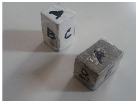
شکل ۴- تصویر یکی از نمونه‌ها قبل و بعد از عملیات MDF
