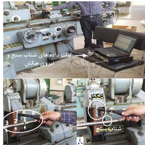
شکل ۸- آنالیز مودال تجربی قطعه کار و تجهیزات مورد استفاده
