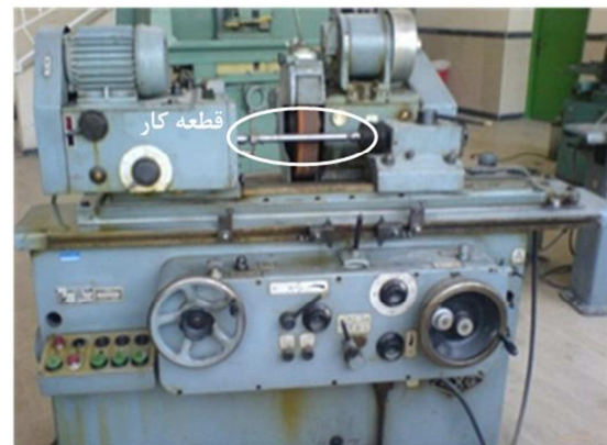
شکل ۴- ماشین سنگ گرد ساب نوع KU250
