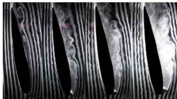
شکل ۱۹- تأثیر موقعیت یخ زدگی بر ساختار جریان در زاویه حمله 10^\circ
