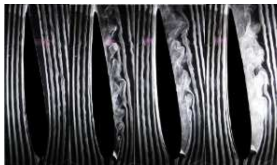
شکل ۱۸- تأثیر موقعیت یخ زدگی بر ساختار جریان در زاویه حمله ۵ درجه
