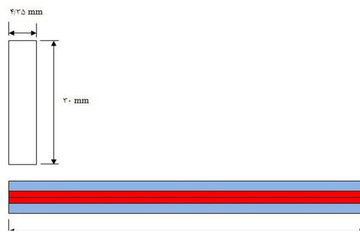
شکل ۴- ابعاد پرتابه و هدف و لایه چینی مد نظر برای هدف ترکیبی
