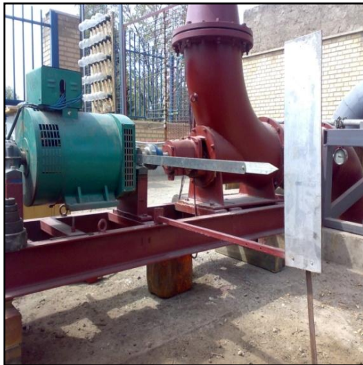
شکل ۸- مدار آزمایش توربین A300
