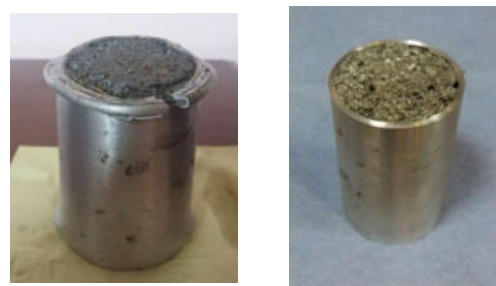
شکل ۱۳- لوله‌ی آلومینیومی پر شده با فوم s2f: الف) قبل از آزمایش ب) بعد از آزمایش
