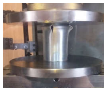
شکل ۱۱- نحوه‌ی قرارگیری نمونه بین صفحات تخت
