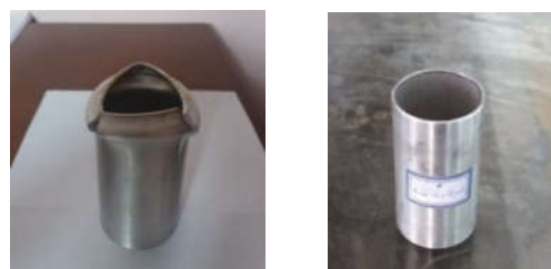
شکل ۱۲- لوله آلومینیومی s2: الف) قبل از آزمایش ب) بعد از آزمایش
