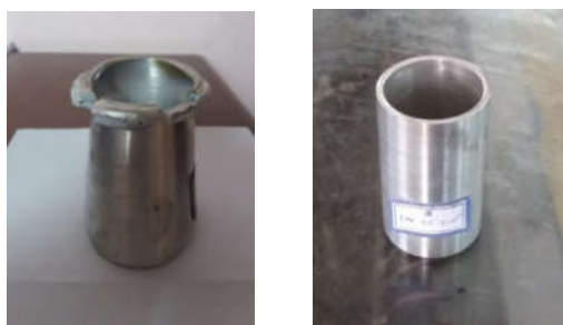
شکل ۷- لوله آلومینیومی s3: الف) قبل از آزمایش ب) بعد از آزمایش
