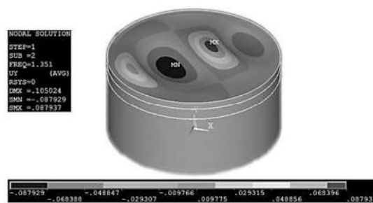
شکل ۸- شکل مود و فرکانس دوم تلاطم سیال در مخزن استوانه‌ای.
