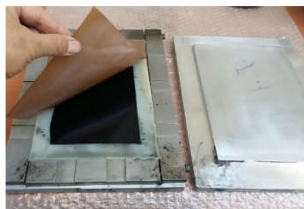
شکل ۳- قالب مورد استفاده برای ساخت نمونه‌های بالکی از چسب
