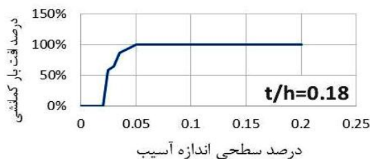
شکل ۱۶- نمودار درصد افت بار کمانشی با افزایش اندازه جدایش بین لایه اول و دوم
