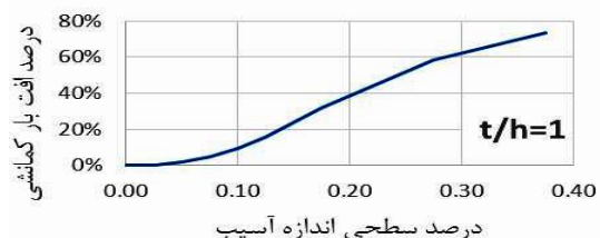
شکل ۱۹- نمودار درصد افت بار کمانشی با افزایش اندازه جدایش بین چندلایه پوسته و هسته
