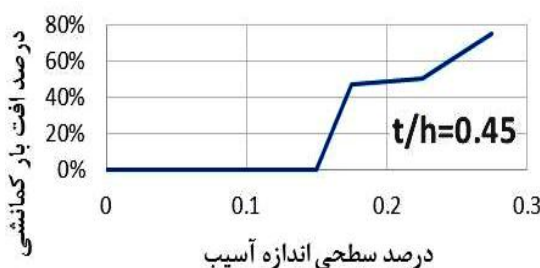
شکل ۱۷- نمودار درصد افت بار کمانشی با افزایش اندازه جدایش بین لایه دوم و سوم
